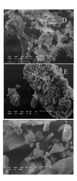
**Figura 1:** Micrografias eletrônicas dos biocatalisadores: (A) Rhizopus oryzae livre (500 X), (B) Rhizopus oryzae imobilizada com TMOS (500 X), (C) Rhizopus oryzae imobilizada com TEOS (500 X), (D) Amano M livre (1000 X), (E) Amano M imobilizada com TMOS (1000 X), (F) Amano M imobilizada com TEOS (1000 X)
