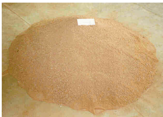
Figura 1- Amostra de agregado miúdo( areia reciclada). Fonte: http://www.reciclagem.pcc.usp.br/a_utilizacao_entulho.htm
